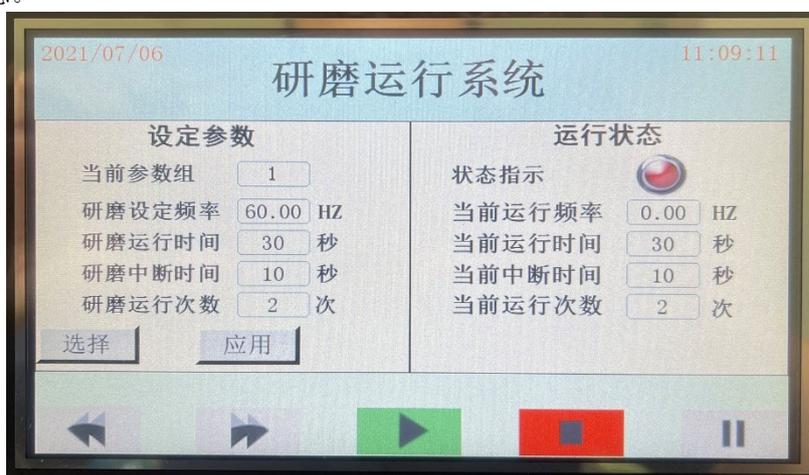
图6. TissueMaster™高通量组织研磨仪(1.5/2ml×48)“研磨运行系统”在“选择”、“应用”后的界面。
